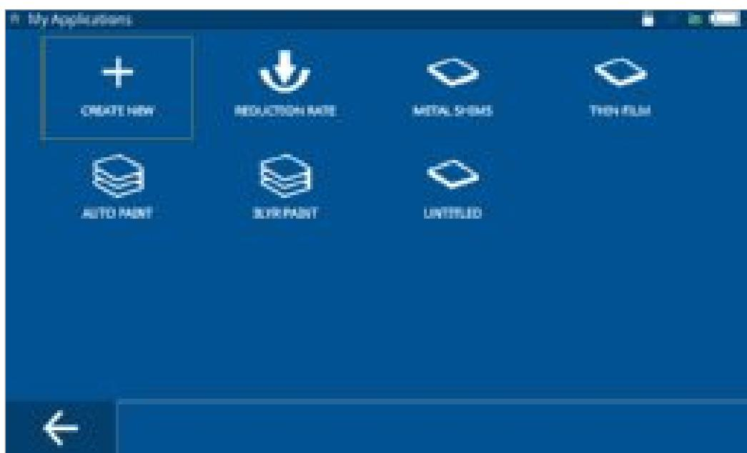
“我的应用”菜单使用预先定义的配置，如单层、多层、屏障和缩减率，可以在测厚仪上轻松地创建自定义应用。这个菜单可指导您完成创建自定义应用过程从选择检测配置到设置探头、材料、报警和报警条件、测量模式和工件图的每个步骤。创建了应用后，就可以轻松访问应用，只需启动测厚仪，测厚仪的启动屏幕上就会显示“我的应用”菜单，因此，可以快速调用所需的应用。
